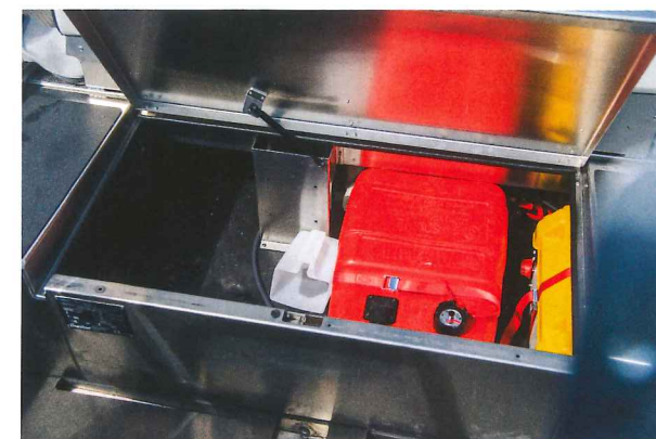
▲ Stuvn under aktersoffan fylls till stor del av soppadunk och batteri. Men du kan få ned en stor väska på styrbordssidan i bänken.
