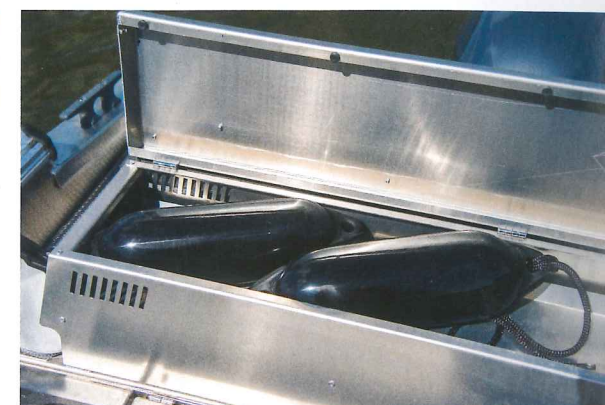
▲ Ryggstödet i aktersoffan går att öppna. Här kan du stoppa ned saker som exempelvis fendrar som går att komma åt även om någon sitter i soffan.
