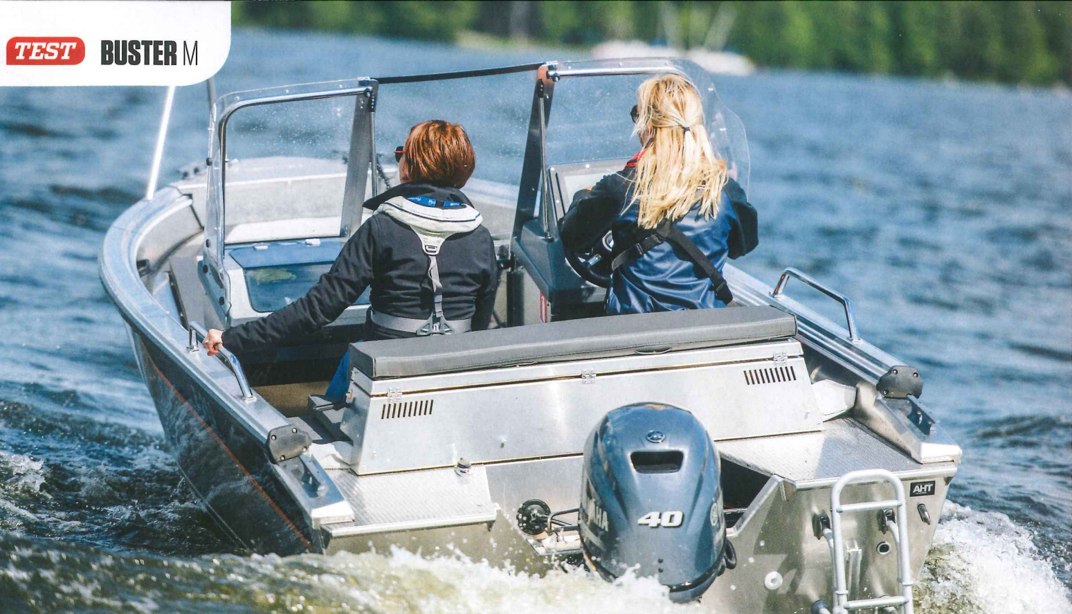
▲ 2018 års Buster M har Yamaha F30 och F40 som motoralternativ. En helt ny bottenform gör att båten lättare än tidigare kommer upp i plan, även när den är rejält lastad.
